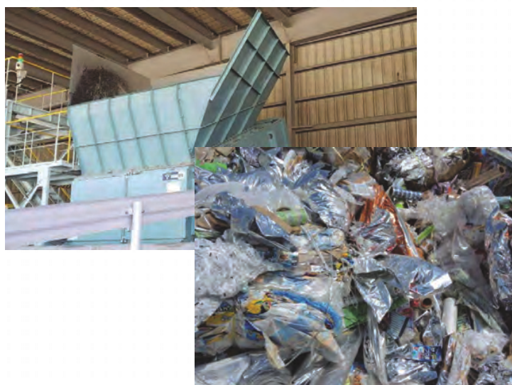
エネルギー代替廃棄物の利用 (粉碎設備と廃プラスチック※)
