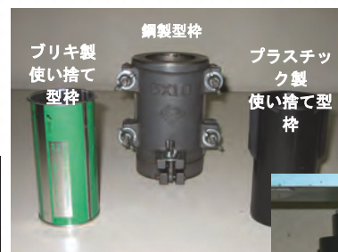
円柱供試体の型枠
