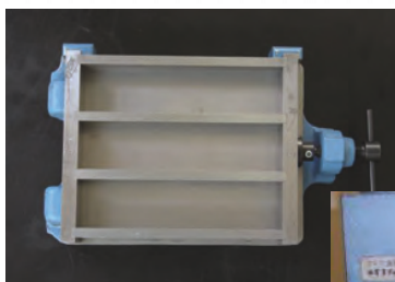
角柱供試体の型枠
