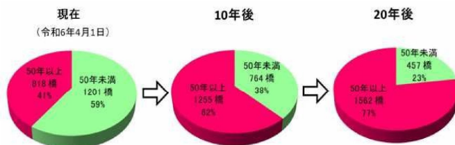
図 1-2 架設後の経過年代別橋梁数
