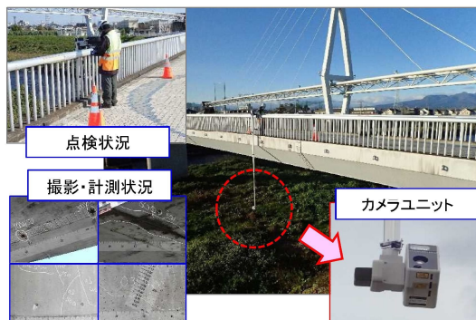
新技術活用 技術名称: 橋梁点検ロボットカメラ 点検支援技術性能カタログ(案)技術番号: BR010019-V0120
