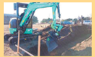
チルトローテータによりアタッチメントの傾斜(チルト)や回転(ローテーション)が可能
