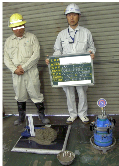
写真-1.4 試験練り（流動化剤添加）
